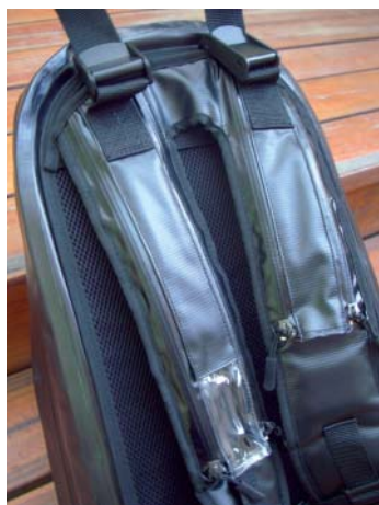
防水肩帶熱壓成型技術開發成品
